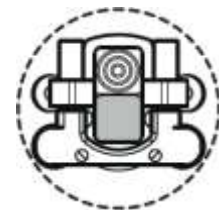
Exemple : détecteur avec fixations placées dans l'alésage.
